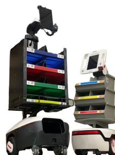
**Autonomous Mobile Robot（AMR）**とは、自律走行型の移動ロボットのことを指します。**AMR**はセンサーやカメラなどの装置を搭載しており、周囲の環境を認識し自律的に移動することができます。
